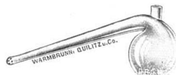
Die Retorte wird zu drei Vierteln mit gewöhnlichem Wasser gefüllt. Der Retortenhals wird entsprechend der Abbildung in die Vorlage geschoben, nachdem der Kühlbehälter mit kaltem Wasser gefüllt ist. Der Retortentubus wird durch Watte usw. geschlossen.
